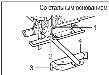
► Рис.20: 1. Шестигранный ключ 2. Болт 3. Направляющая планка (направляющая линейка) 4. Направляющая
