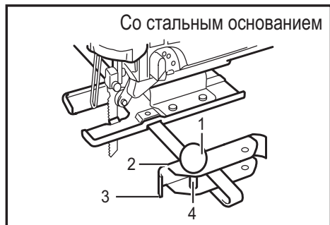
► Рис.22: 1. Резьбовая ручка 2. Направляющая планка смотрит 3. Направляющая планка (направляющая линейка) 4. Штифт
