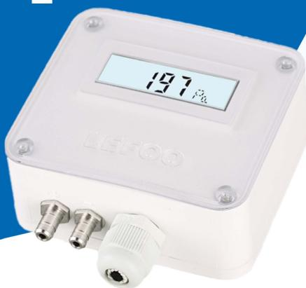
Датчик давления воздуха LFM11 определяет давление в каналах систем вентиляции, а затем преобразует давление или разницу давлений в пропорциональный аналоговый выходной сигнал. Датчики были специально разработаны для автоматизации систем HVAC, мониторинга давления и расхода, а также для испытаний на низкий перепад давления в промышленности.
