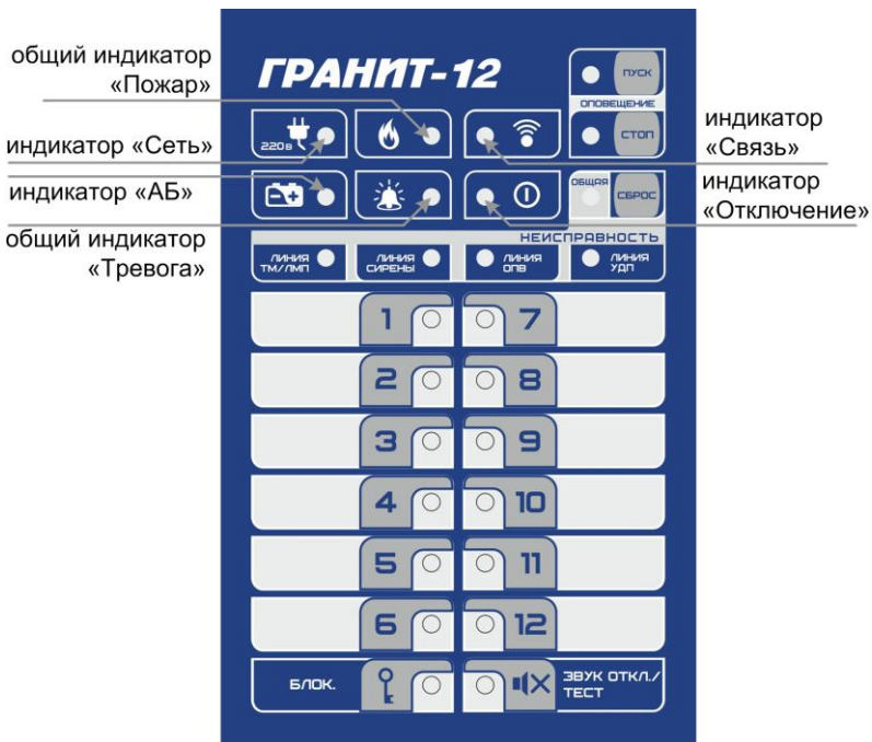
Рис.2 Панель индикации и управления прибора Гранит-12
