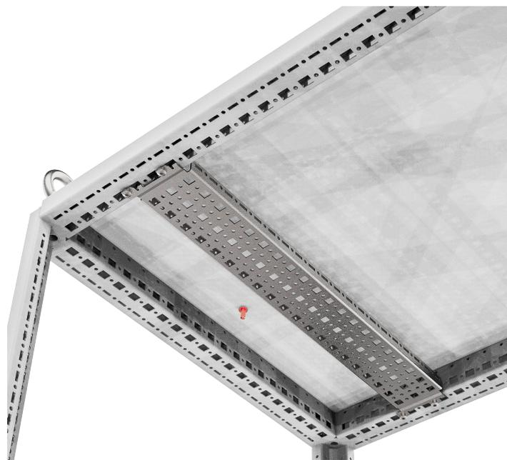
Планка монтажная с зацепами 20x73 тип К RS52 предназначена для монтажа навесного оборудования при помощи резьбовых винтов с шагом 12,5 мм, клетьевых гаек с шагом 25,0 мм. Планка навешивается на профиль крыши и основания рамы RS52.
