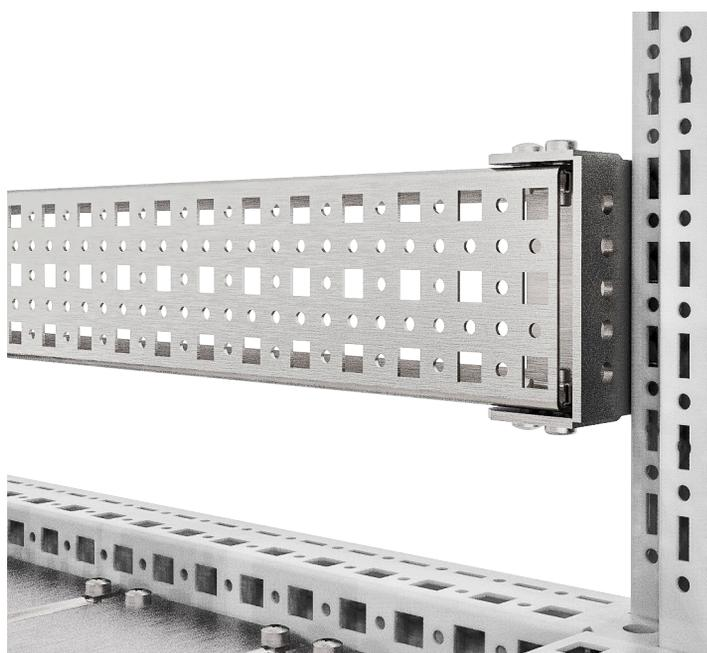
Планка монтажная 23x73 предназначена для монтажа навесного оборудования при помощи резьбовых винтов с шагом 12,5 мм, клетьевых гаек и винтов с шагом 25,0 мм. Крепится при помощи специальных комплектов крепления планок. Дополнительно необходимо приобрести комплект крепления планок RS52 23x73.
