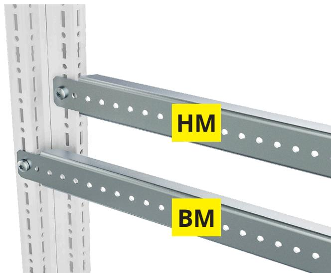
Предназначена для монтажа облегченного навесного оборудования при помощи резьбовых выдавливающих винтов с шагом 12,5 мм. Рейка крепится на наружный монтажный уровень рамы RS52. Статическая нагрузочная способность одной рейки до 50 кг.
