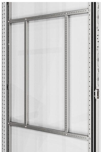
Рейка глухой двери предназначена для монтажа оборудования на внешние глухие двери шкафов RS52 в качестве горизонтальных или вертикальных направляющих для обеспечения крепления к ним проводников и иного шкафного оборудования. Статическая нагрузочная способность одной рейки до 50 кг.
