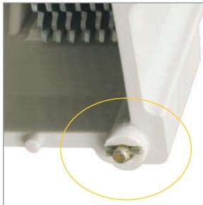
Верхняя крышка закреплена при помощи винтов с фиксацией. Это исключает самопроизвольное развинчивание. Поэтому контакторы серии КТИ можно устанавливать в места, где присутствует постоянная рабочая вибрация.
