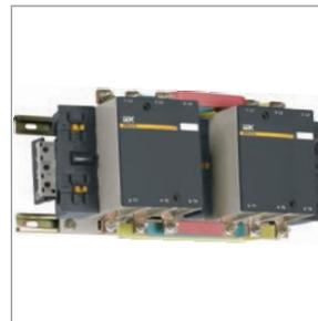
Собранный на заводе реверсивный контактор поставляется с заводскими шинами и механической блокировкой. Контактные группы смонтированы на двух металлических рейках, что обеспечивает высокую жесткость конструкции. Реверсивные контакторы КТИ представляют собой отдельную группу в ассортименте компании.
