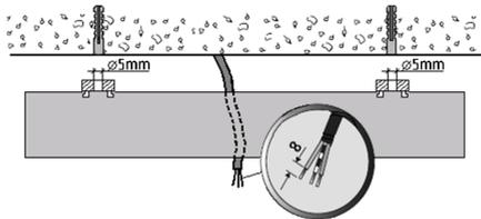
4. Установить корпус на поверхность потолка.
