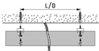
5. Подключить сетевой провод к клеммной колодке в соответствии с указанной полярностью.
