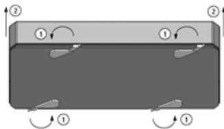
2. Вклацнути опору в корпус світильника.
