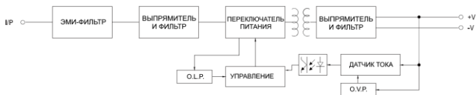
Рисунок 4. Принципиальная схема блока питания.
