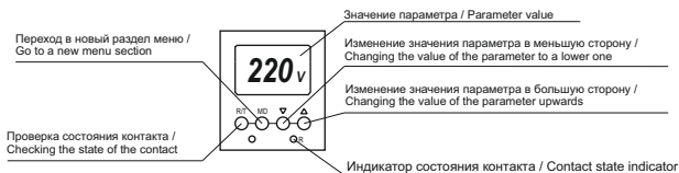
Рисунок / Figure 9 – Назначение органов управления реле / The assignment of the relay controls ORF-S
