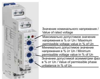
Рисунок / Figure 6 – Назначение органов управления реле ORF-06D / The assignment of the relay controls ORF-06D
