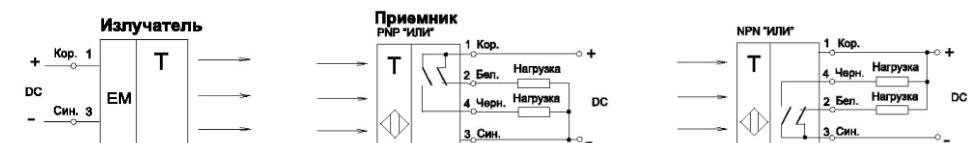
Рис. 2 Схемы подключения ВБО
