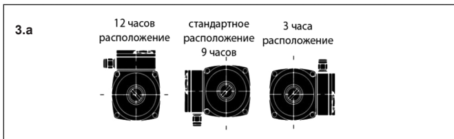
Рис.3 - ДОПУСТИМЫЕ ПОЛОЖЕНИЯ КЛЕММНОЙ КОРОБКИ
