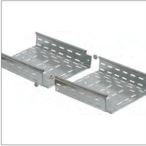
Лотки соединяются с помощью разъемов «мама-папа» и прочно фиксируются комплектом соединительным КС М6×10. Стандартная длина лотков – 3 метра.
