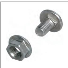
Все лотки и аксессуары соединяются между собой при помощи унифицированного комплекта соединительного КС М6×10. Таким образом, для сборки трассы любой степени сложности необходимо всего три вида метизов. Благодаря квадратному подголовнику, фиксирующему болт из комплекта соединительного КС М6×10, для соединения лотков и аксессуаров нужен только один ключ М10.
